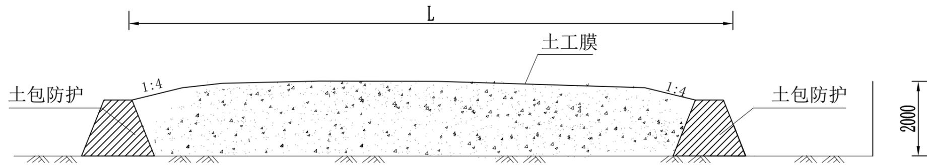
A-A 耕作层临时储存区剖面示意图 1:50
